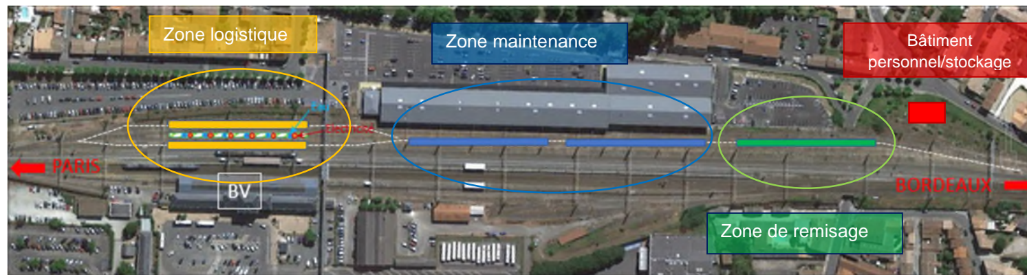
Figure 11 : Plan de configuration des voies de service
