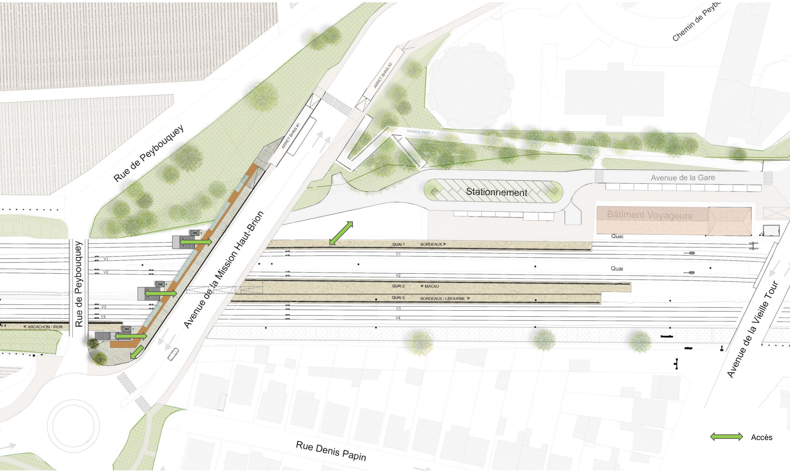
Figure 29 : Projet de halte de Talence-Médoquine et présentation des accès aux quais et à la passerelle
